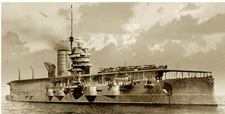
Россия. Эскадренный аэропланосец "Императрица Екатерина II" 1916 г. (22500 тонн) 22 узл. 20 аэропланов. Артиллерия: XII - 6 дм. VI - 3 дм.
