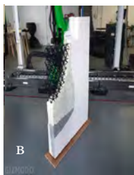
Рисунок 4. 3d-печать объектов строительства: а – 3d-принтер для строительства; б – пример возведенного жилого дома; в – выполнение печати отдельной конструкции здания.
